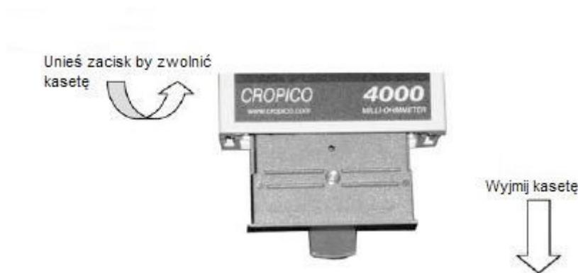
Wymiana baterii możliwa jest po odkręceniu śrubki podtrzymującej pokrywę kasety. Należy pamiętać o właściwej polaryzacji.
