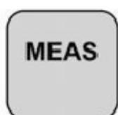
Jednokrotne wciśnięcie uruchamia pomiar. Wciśnij i przytrzymaj aż usłyszysz dźwięk aby włączyć ciągły tryb pomiaru.
