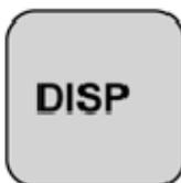
Przełącza widok wyświetlacza pomiędzy pomiarem rezystancji a temperatury
