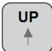
Zmienia zakres pomiarowy na wyższy. Służy również do zwiększania wartości liczbowych współczynników kompensacji lub kodu kalibracji
